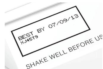
Hinweis: Alle Codes werden mit einer Geschwindigkeit von 95 Metern pro Minute gedruckt
